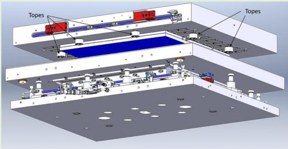
Figura 3. Molde espejo penetrante con topes.
