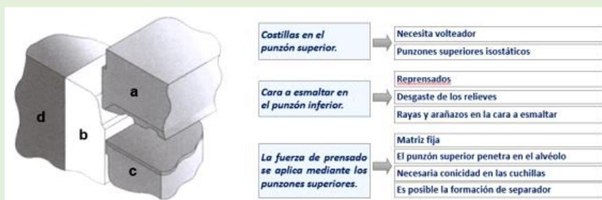
Figura 6. Esquema de funcionamiento de un molde penetrante.
